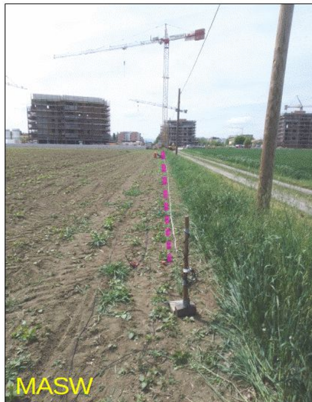
Foto 2.2 - Stendimento sismico MASW/ReMi eseguito per questo studio
