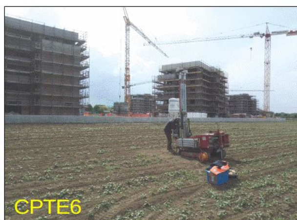
Foto 2.1 - Prove penetrometriche CPTU eseguite per questo studio
