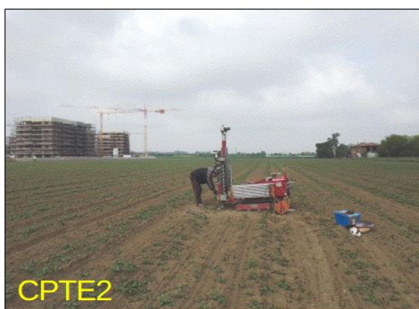
Foto 2.1 - Prove penetrometriche CPTU eseguite per questo studio
